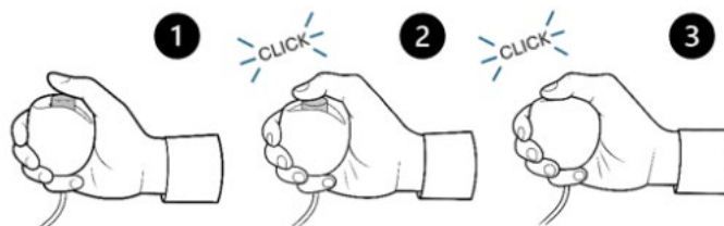
Figura 1 – Pozițiile întrerupătorului de mână de expunere.
